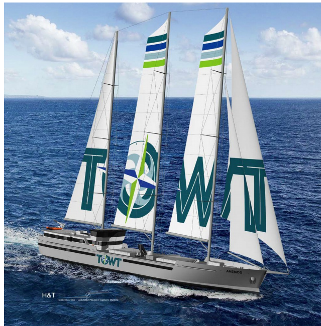
photo 3: Voilier-cargo de 67,50 m, naviguant à 12 noeuds et semi-automatisé. (Crédit : TOWT)
