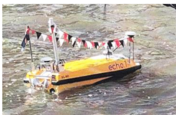
Figure 7: Surveillance bathymétrique port de Hambourg
